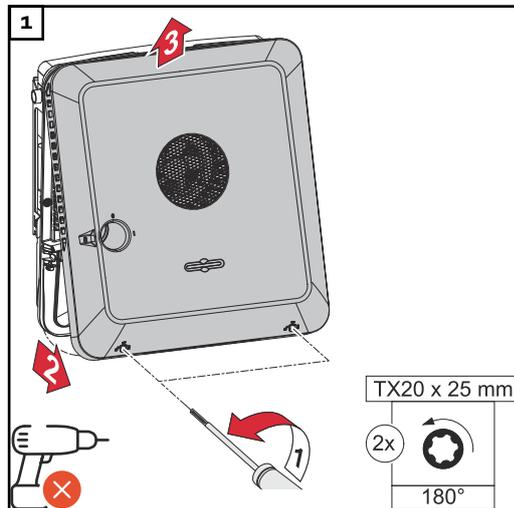
Die 2 Schrauben an der Unterseite des Gehäusedeckels mit einem Schraubendreher (TX20) und einer 180°-Drehung nach links lösen. Anschließend den Gehäusedeckel an der Unterseite vom Wechselrichter anheben und nach oben aushängen.
