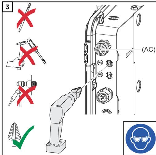
Die optionale Kabelführung mit einem Stufenbohrer aufbohren.
