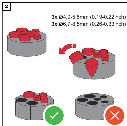
Den Dichtungsring an der Stelle, an welcher der Blindstopfen entfernt werden soll, aufspreizen.
