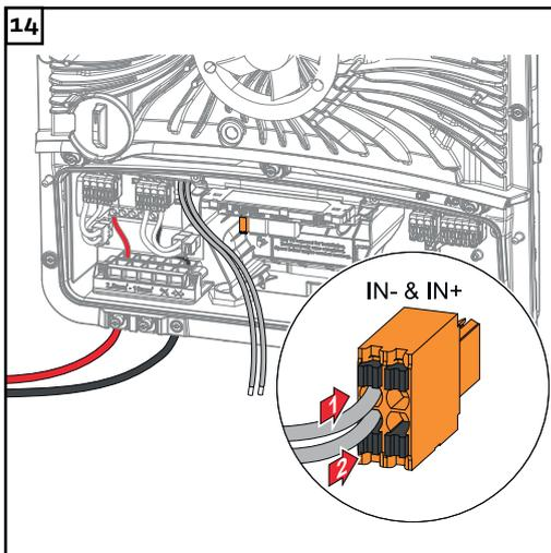
Signalkabel unter Berücksichtigung der Beschriftung an die Push-in Anschlussklemme WSD auf den Steckplätzen IN- und IN+ anschließen.
