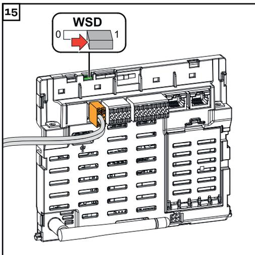
Kontrollieren, ob sich der WSD-Switch auf Position 1 befindet, ggf. einstellen (Werkseinstellung: Position 1).
