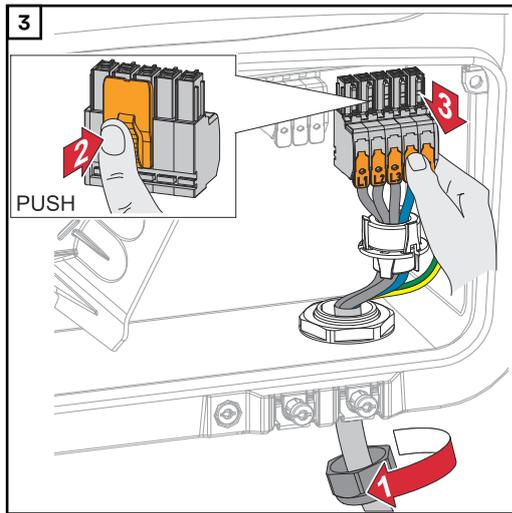
Die Verriegelung an der Rückseite der Anschlussklemme drücken und die AC-Anschlussklemmen abziehen. Die Kabelverschraubung lösen.
