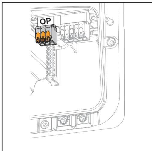
Mit dem PV Point können an der Opportunity Power (OP) Anschlussklemme bei Ausfall des öffentlichen Netzes 1-phasig elektrische Geräte bis zu einer max. Leistung von 3 kW versorgt werden, wenn dazu genügend Leistung von den Solarmodulen oder einer optionalen Batterie zur Verfügung steht. An der OP-Anschlussklemme liegt im netzgekoppelten Betrieb keine Spannung an, daher werden die angeschlossenen Lasten nicht dauerhaft versorgt.
