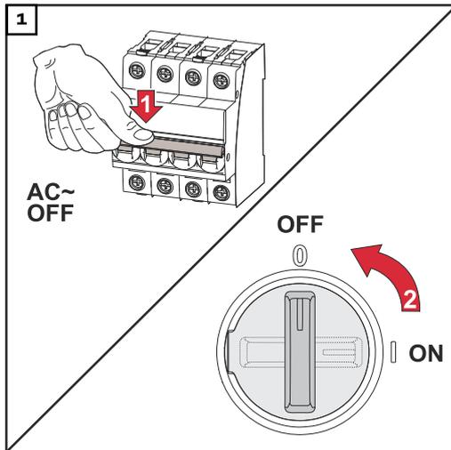
Den Wechselrichter stromlos schalten und die Entladezeit (2 Minuten) der Kondensatoren sowie den Stillstand des Lüfters abwarten.
