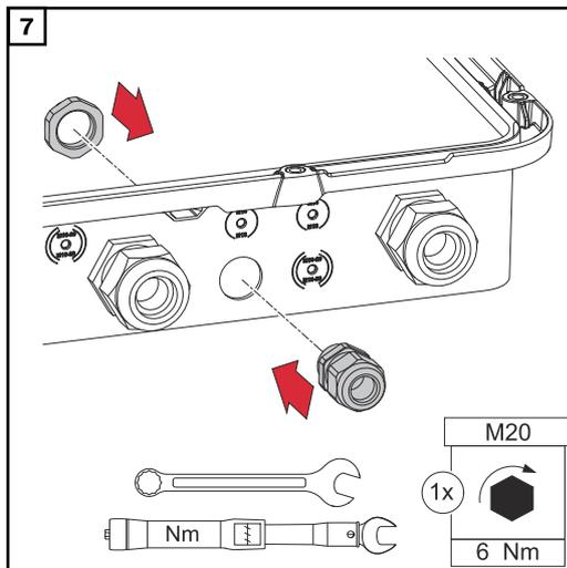
Die Kabelverschraubung in die Bohrung einsetzen und mit einem Drehmoment von 6 Nm befestigen.
