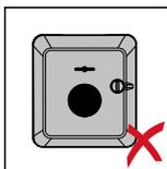
Den Wechselrichter nicht mit den Anschlüssen nach oben an einer senkrechten Wand oder Säule montieren.
