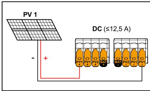
Strom kleiner/gleich 12,5 A ( $I_{dcmax}$ ).
