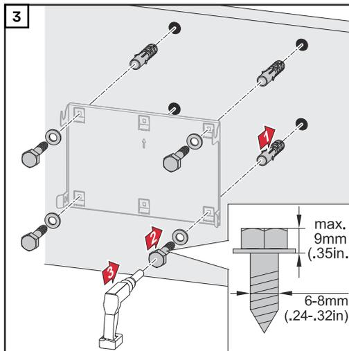
**Montagehalterung auf einem Mast oder Träger montieren**
