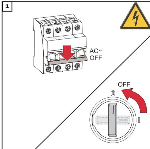
Den Leitungs-Schutzschalter und DC-Trenner ausschalten. DC-Trenner auf Schalterstellung „Aus“ schalten.
