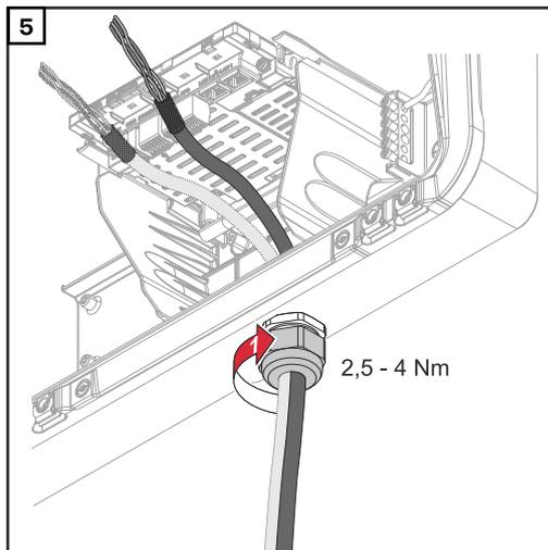
Die Überwurfmutter der Kabelverschraubung mit einem Drehmoment von min. 2,5 - max. 4 Nm befestigen.
