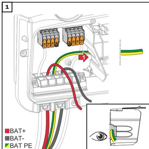
Den Schutzleiter der Batterie in den integrierten Kabelkanal der Abtrennung des Anschlussbereichs in den AC-Anschlussbereich verlegen.
