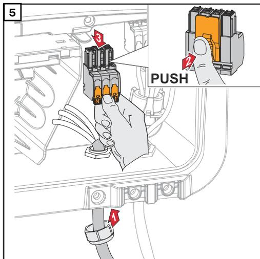
Das Netzkabel von unten durch die Kabelverschraubung führen.
