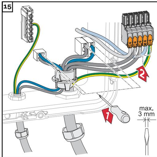
Die abisolierten Phasen-/Neutralleiter an den vorgesehenen Anschlussklemmen anschließen.
