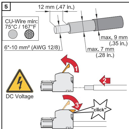
Kabel-Querschnitt gemäß der Angaben in [Zulässige Kabel für den elektrischen Anschluss](#) ab Seite 54 wählen. Von den Einzelleitern 12 mm abisolieren. Den Betätigungshebel der Anschlussklemme durch Anheben öffnen und den abisolierten Einzelleiter in den jeweils vorgesehenen Steckplatz bis zum Anschlag in die Anschlussklemme stecken. Danach den Betätigungshebel bis zum Einrasten schließen.
