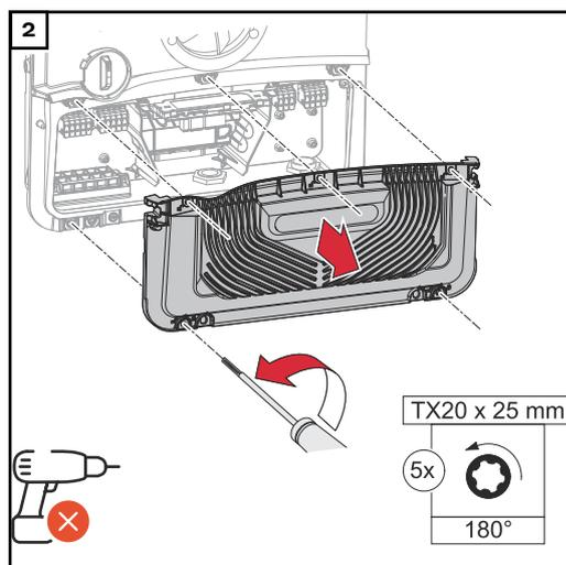
Die 5 Schrauben der Abdeckung des Anschlussbereichs mit einem Schraubendreher (TX20) und einer 180°-Drehung nach links lösen. Die Abdeckung des Anschlussbereichs vom Gerät nehmen.
