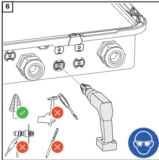
Die optionale Kabeldurchführung mit einem Stufenbohrer aufbohren.
