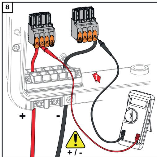
Mit einem geeigneten Messgerät die Spannung und Polarität der DC-Verkabelung überprüfen. Beide DC-Anschlussklemmen aus den Steckplätzen entnehmen.
