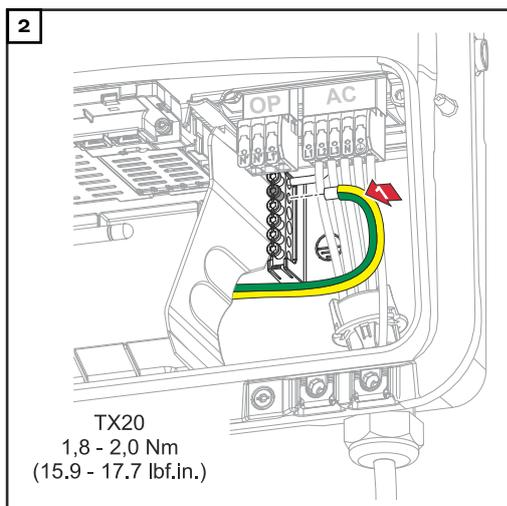
Den Schutzleiter der Batterie am zweiten Eingang von oben an der Erdungselektroden-Klemme mit einem Schraubendreher (TX20) und einem Drehmoment von 1,8 - 2 Nm befestigen.
