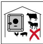
Den Wechselrichter nicht montieren in:
