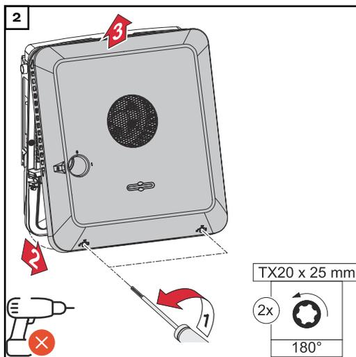
Die Schrauben an der Unterseite des Gehäusedeckels mit einem Schraubendreher (TX20) und einer 180°-Drehung nach links lösen. Anschließend den Gehäusedeckel an der Unterseite vom Wechselrichter anheben und nach oben aushängen.
