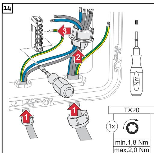
Die Phasen-/Neutraleiter durch den Ferritkern durchführen. Den Schutzleiter am dritten Eingang von oben an der Erdungselektroden-Klemme mit einem Schraubendreher (TX20) und einem Drehmoment von 1,8 - 2 Nm befestigen.
