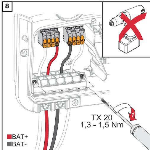
Die Schrauben der Kabelführung mit einem Schraubendreher (TX20) und einem Drehmoment von 1,3 - 1,5 Nm am Gehäuse befestigen.
