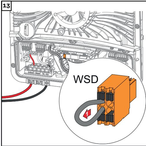
Die werksseitige installierte Überbrückung an der Push-in Anschlussklemme WSD entfernen.
