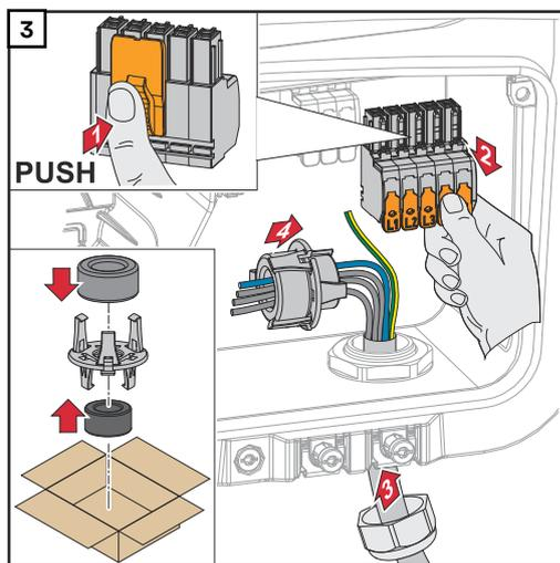
Die Verriegelung an der Rückseite der Anschlussklemme drücken und die AC-Anschlussklemme abziehen. Das Netzkabel von unten durch die an der rechten Seite befindliche Kabelverschraubung und den Ferritkern führen.
