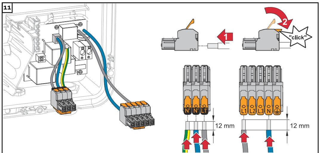
Von den Einzelleitern 12 mm abisolieren. Den Betätigungshebel der AC-Anschlussklemme durch Anheben öffnen und den abisolierten Einzelleiter in den vorgesehenen Steckplatz bis zum Anschlag in die AC-Anschlussklemme stecken. Danach den Betätigungshebel bis zum Einrasten schließen.
