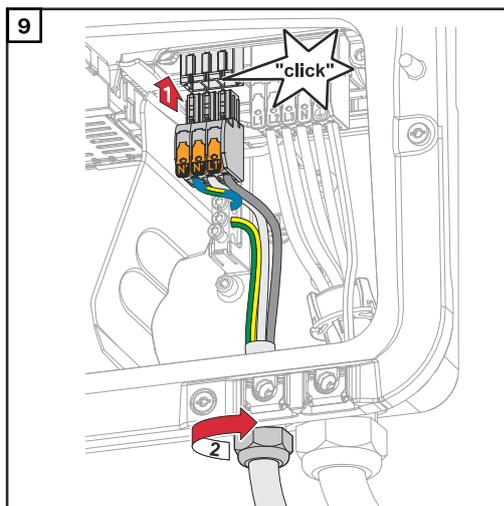
Die OP-Anschlussklemme in den OP-Steckplatz stecken, bis diese einrastet. Die Überwurfmutter der Kabelverschraubung mit dem vom Hersteller angegebenen Drehmoment befestigen.
