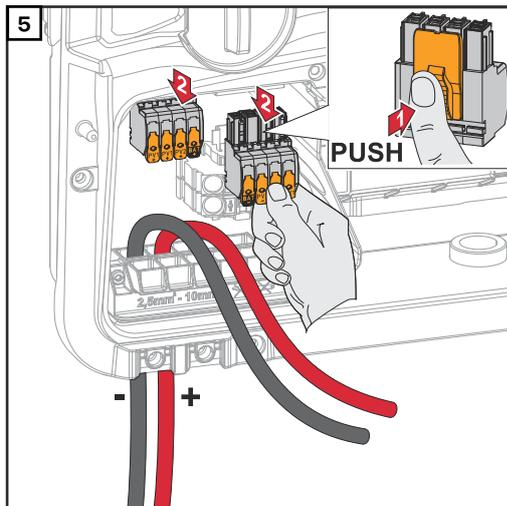
Die Verriegelung an der Rückseite der Anschlussklemme drücken und die DC-Anschlussklemmen abziehen.
