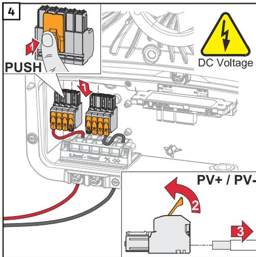
Die DC Push-in Anschlussklemmen aus den Steckplätzen entfernen und von den Kabeln abschließen (nur bei bereits existierender Installation notwendig).
