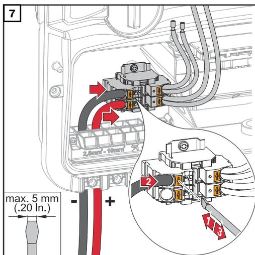
Die Verriegelung der Anschlussklemme mit einem Schlitz-Schraubendreher drücken. Den abisolierten Einzelleiter in den jeweils vorgesehenen Steckplatz bis zum Anschlag in die Anschlussklemme stecken. Danach den Schlitz-Schraubendreher von der Verriegelung entfernen.
