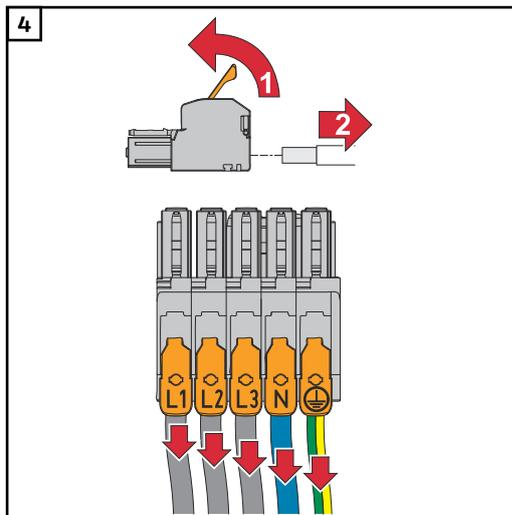
Die Einzelleiter von der AC-Anschlussklemme abschließen (nur bei bereits existierender Installation notwendig).
