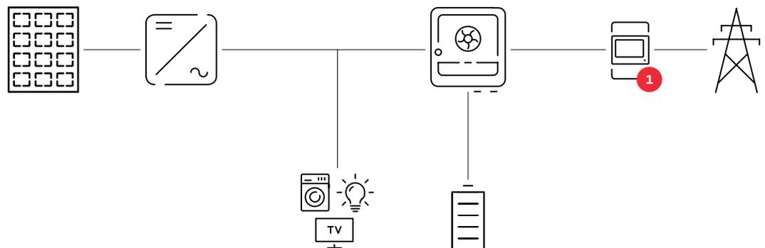
**Betriebsmodus - Wechselrichter mit Batterie und Ohmpilot**
