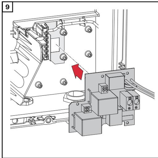
Den Print in den Wechselrichter einsetzen.
