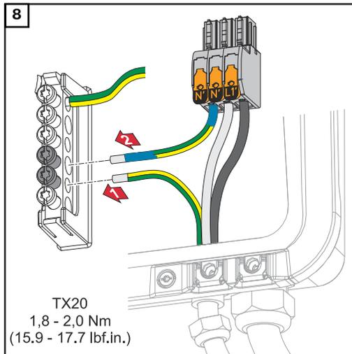
Den Schutzleiter und PEN-Leiter an der Erdungselektroden-Klemme mit einem Schraubendreher (TX20) und einem Drehmoment von 1,8 - 2 Nm befestigen.
