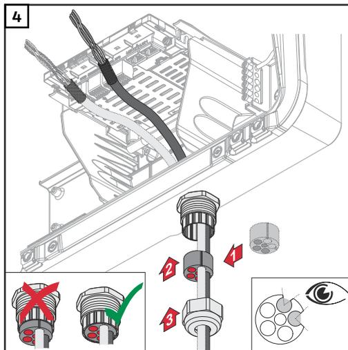
Dichtungsring zwischen der Überwurfmutter und der Gehäuseöffnung einsetzen. Die Datenkabel in die Kabelführung der Dichtung eindrücken. Danach die Dichtung bis zur Unterkante der Kabelverschraubung hineindrücken.
