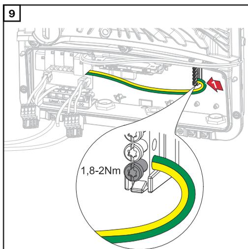
Den Schutzleiter am ersten Eingang von unten an der Erdungselektroden-Klemme mit einem Schraubendreher (TX20) und einem Drehmoment von 1,8 - 2 Nm befestigen.
