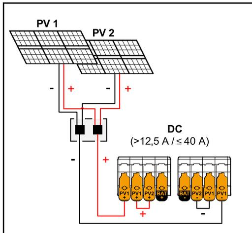
Kombinierte Solarmodul-Stränge mit Summenstrom größer 12,5 A ( $I_{dcmax}$ ).
