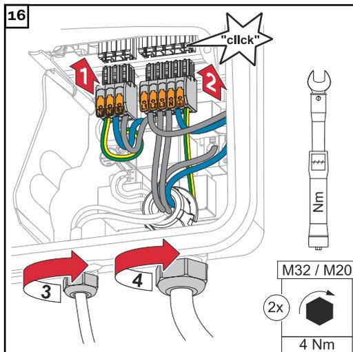
Die Anschlussklemmen in den jeweiligen Steckplatz stecken, bis diese einrasten. Die Überwurfmutter der Kabelverschraubungen mit einem Drehmoment von 4 Nm befestigen.
