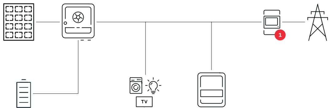
**Betriebsmodus - Wechselrichter mit Batterie und weiterem Wechselrichter**
