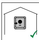
Der Wechselrichter ist für die Montage im Innenbereich geeignet.
