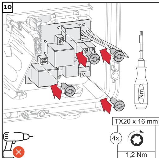
Den Print mit den 4 mitgelieferten Schrauben (TX20) und einem Drehmoment von 1,2 Nm befestigen.
