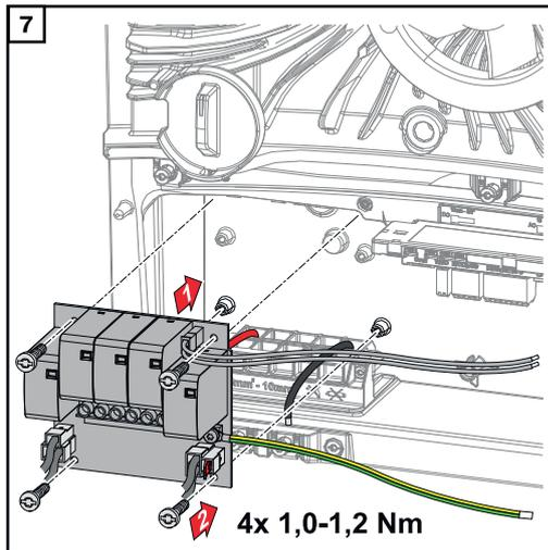
Den Print in den Wechselrichter einsetzen und mit den 4 mitgelieferten Schrauben (TX20) und einem Drehmoment von 1,0 - 1,2 Nm befestigen.
