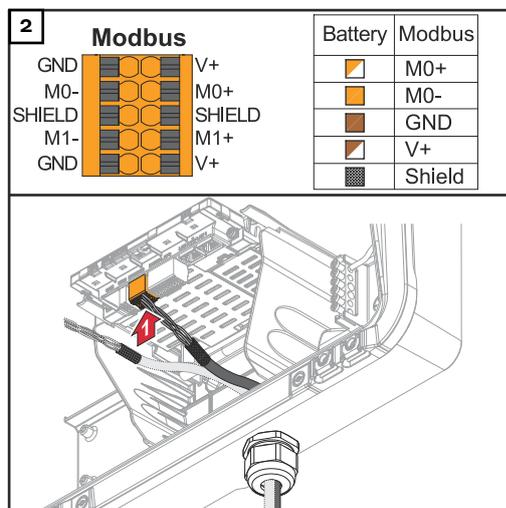
Die Kabel in den jeweiligen Steckplatz stecken und den Halt der Kabel prüfen.
