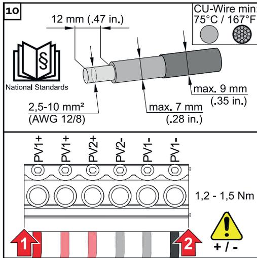
Von den Einzelleitern 12 mm abisolieren und an den jeweils vorgesehenen Steckplatz der am Print befindlichen Anschlussklemme mit einem Drehmoment von 1,2 - 1,5 Nm befestigen.
