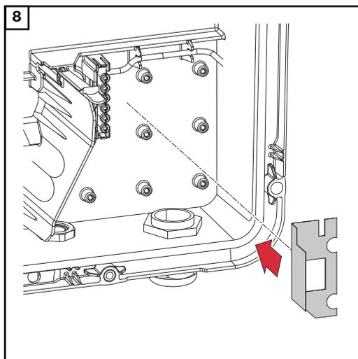
Die Isolierfolie an der rechten Seite der Erdungselektroden-Klemme einsetzen.
