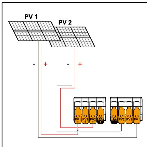
PV 1 kleiner/gleich 20 A ( $I_{SC\ PV1}$ )
