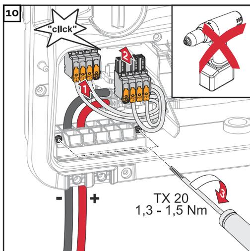
Die DC-Anschlussklemmen in den jeweiligen Steckplatz stecken, bis diese einrasten. Die Schrauben der Zugentlastung mit einem Schraubendreher (TX20) und einem Drehmoment von 1,3 - 1,5 Nm am Gehäuse befestigen.
