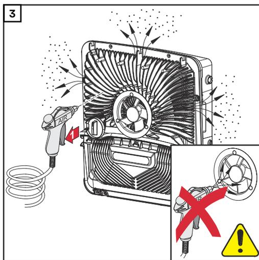
Die Schmutzablagerungen am Kühlkörper und Lüfter mit Druckluft oder einem Tuch oder einem Pinsel entfernen.
