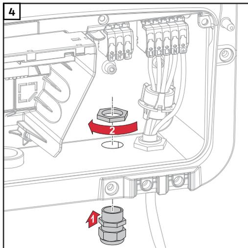
Kabelverschraubung in die Bohrung einsetzen und mit dem vom Hersteller angegebenen Drehmoment befestigen.
