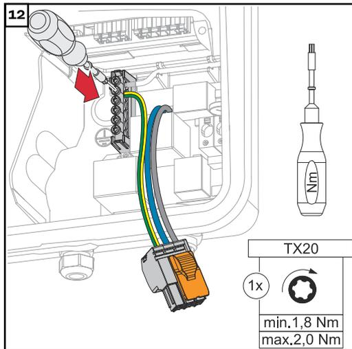
Die mitgelieferte PEN-Verbindung am zweiten Eingang von oben an der Erdungselektroden-Klemme mit einem Schraubendreher (TX20) und einem Drehmoment von 1,8 - 2 Nm befestigen.
