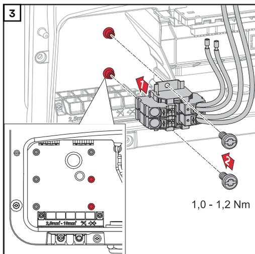
Den DC Connector GEN24 in den Wechselrichter einsetzen und mit den 2 mitgelieferten Schrauben (TX20) und einem Drehmoment von 1,0 - 1,2 Nm befestigen.
