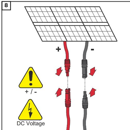
Solarmodul-Stränge (+/-) verbinden.
