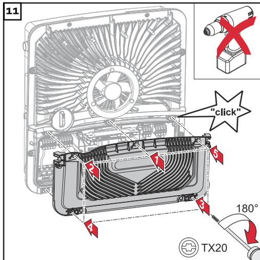
Die Abdeckung auf den Anschlussbereich setzen. Die 5 Schrauben in der angegebenen Reihenfolge mit einem Schraubendreher (TX20) und einer 180°-Drehung nach rechts befestigen.
