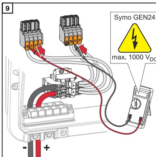
Mit einem geeigneten Messgerät die Spannung und Polarität der DC-Verkabelung überprüfen.
