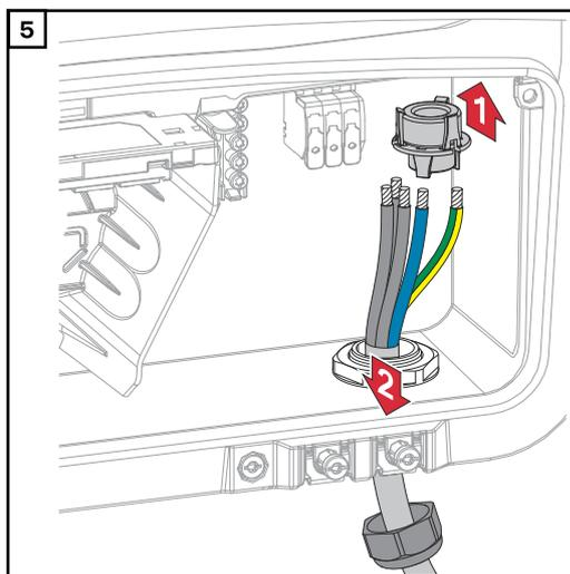
Den Ferritkern abziehen und das Netzkabel aus dem Wechselrichter entfernen.
